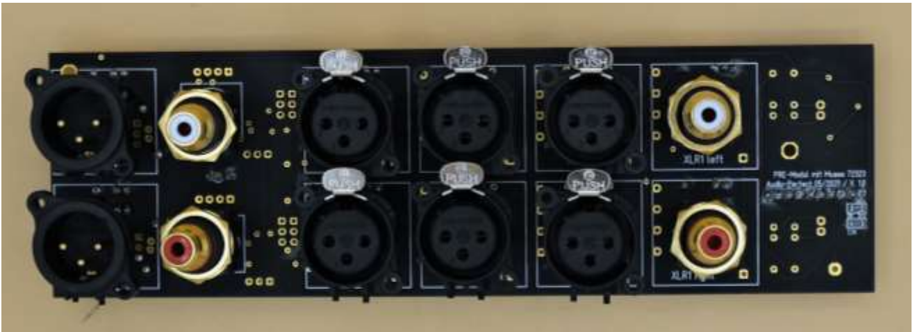
Abbildung 1 - Eingänge: 3 x XLR, 1 x RCA - Ausgänge: XLR und RCA
